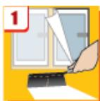
Рабочие поверхности очистить от пыли, грязи, масляных пятен и льда. Увлажнять только пористые строительные материалы, такие как: кирпич, пеноблоки, гипс, бетон, дерево. Гладкие поверхности, такие как: металл, стекло и т.д.- не увлажняются. Оцинкованный металл и профлист тщательно обезжирить перед работой. **ВНИМАНИЕ!** При не качественном обезжиривании поверхности, возможно ухудшение адгезионных свойств. Легкое увлажнение также производится поверх выпущенной изоляции SIPUR®.
