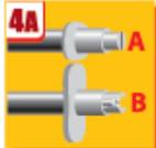
Насадку надеваем: "ушки" параллельно земле (А)-движения слева направо, "ушки" перпендикулярно земле (В)-движения снизу вверх. Нанесение на потолок: рабочее положение "ушки"- перпендикулярно земле (В), движения слева направо.
