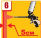
При напылении спусковой крючок пистолета нажимать до упора. Толщина напыленного слоя увеличивается на 20% через 20 минут, поэтому напылять не более 4 см. При необходимости большей толщины, наносить следующий слой через 20 минут после нанесения первого. Перед этим следует убедиться, что нет капель воды на предыдущем слое. Количество слоев не ограничено.
