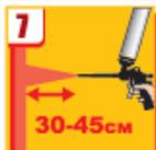
Напыление производят на расстоянии от 30 до 45 см от поверхности в зависимости от формирования факела. Чем больше расстояние - тем шире поверхность напыления.
