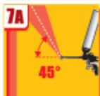
Напыление с помощью угловой насадки позволяет наносить изоляцию SIPUR® на потолок, не меняя правильного положения баллона в пространстве.
