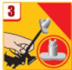
Надеть специальную насадку (входит в комплект) на ствол пистолета до щелчка посредством упора в твердую поверхность (стена, пол и т.д.). Регулировочный винт пистолета открыть на максимальную подачу.
